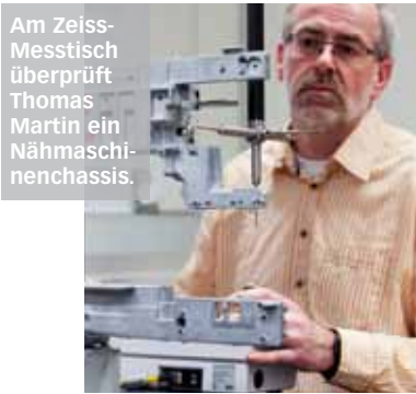
Funktionsspezifische Prüfung in der Testing-Abteilung.
